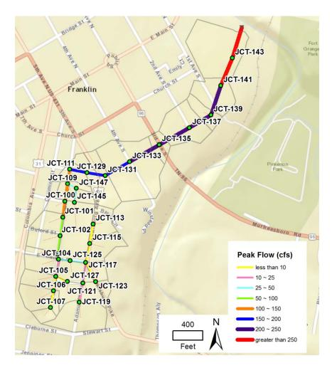
Figure 8: Conduits Maximum Discharge
